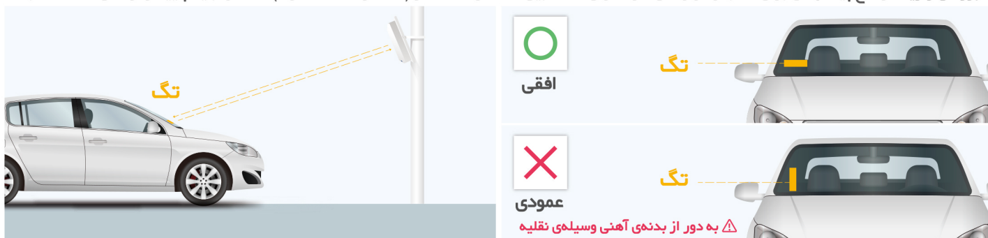
▲ قرارگیری متناظر بین کارتخوان RFID و تگ در تصویر بالا ترسیم شده است. ▲ بررسی سمت و جهت: کاملاً رو به آنتن، به صورت افقی به شکل موازی.
